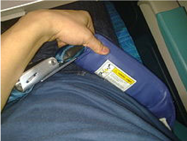
Airbag in einem AIRBUS A330 (Quelle: Airbus)
